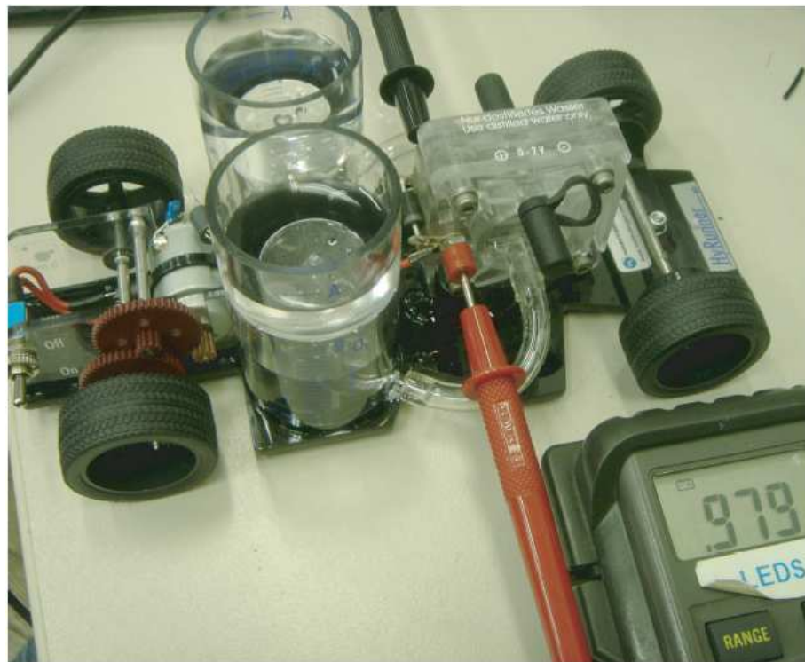
Figura 32 – Medição em circuito aberto
