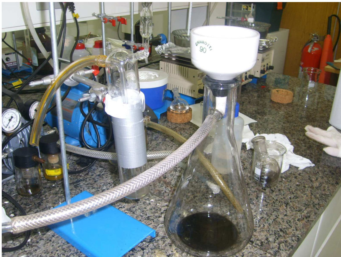
Figura 14 – Filtragem do catalisador
