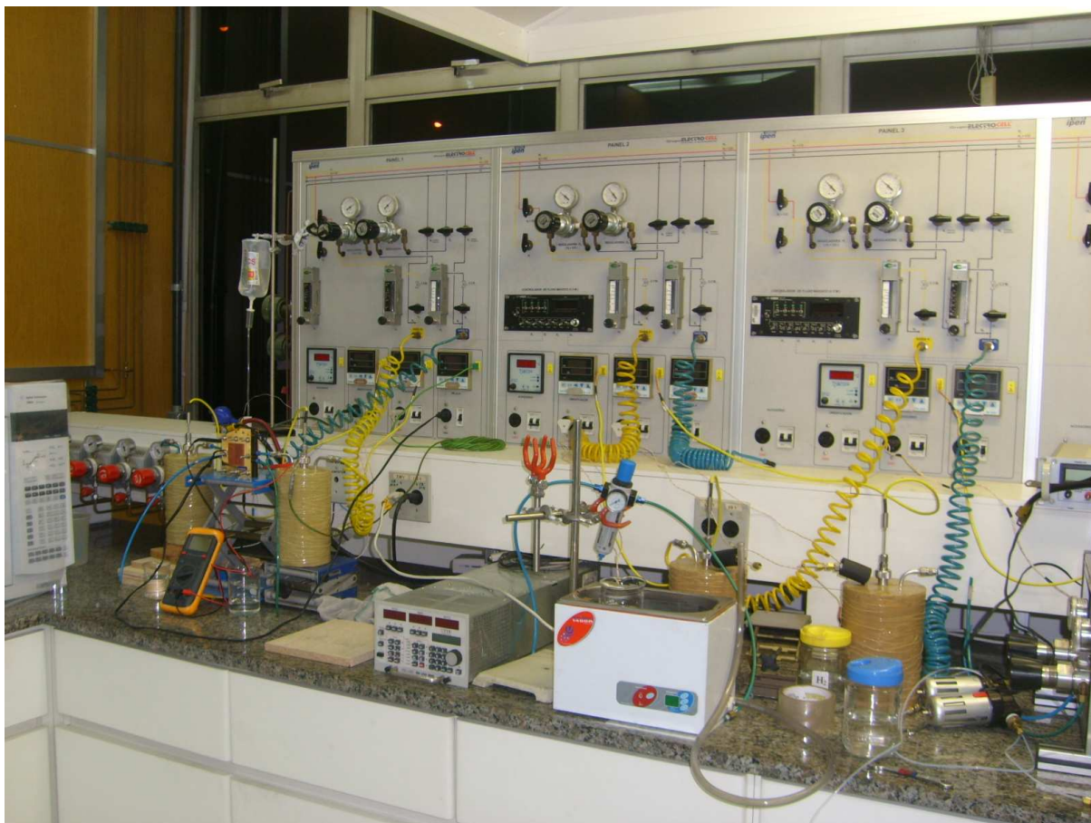
Figura 40 – Bancada de teste de célula combustível no IPEN
