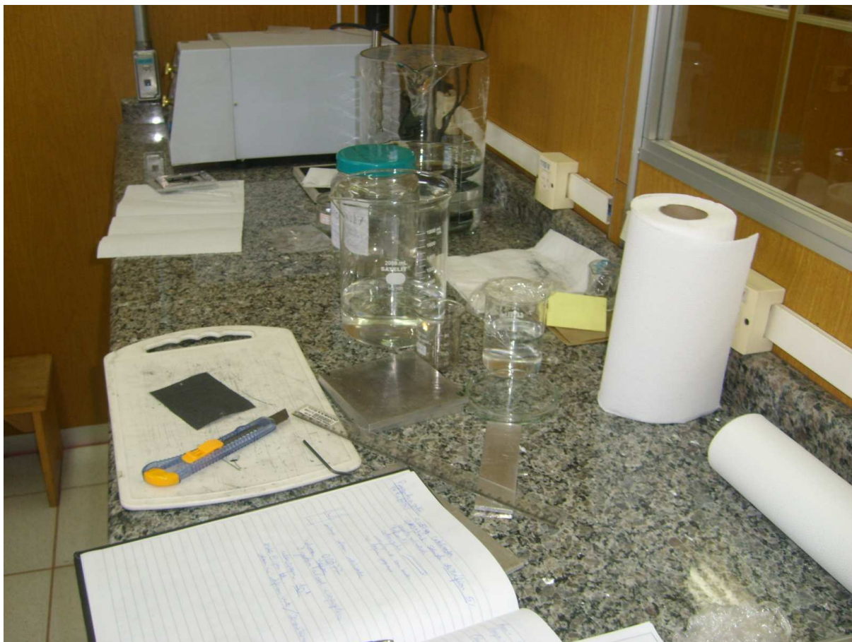
Figura 15 – Corte dos tecidos de carbono.
