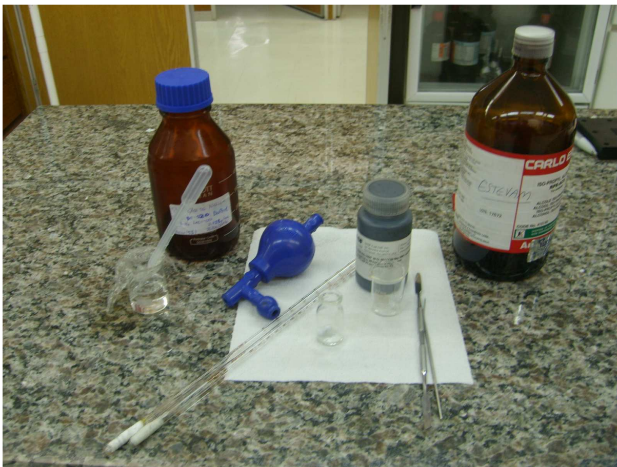
Figura 30 – Preparação da tinta catalítica
